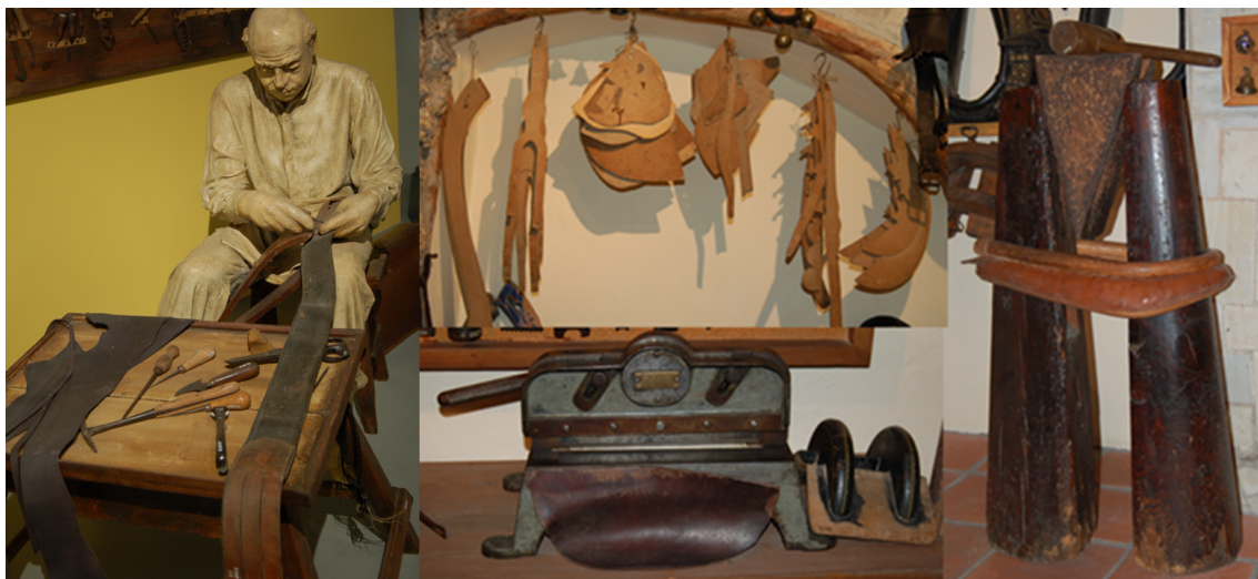
Figura 29. Herramientas y otros instrumentos empleados para la elaboración de las guarniciones de las caballerías. En el centro se pueden ver algunos moldes o patrones, y a la derecha, un sistema para obtener el diámetro deseado para una collera. Museu del Traginer, Igualada.
