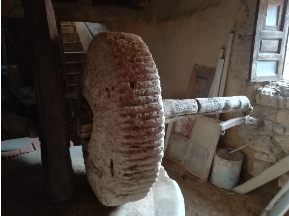
Figura 21. Molino de cascás en la antigua curtiduría de Mota del Marqués.
