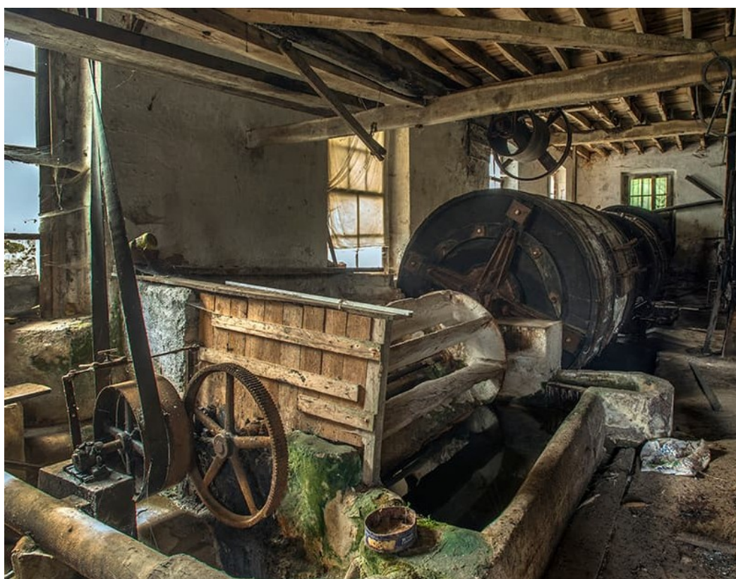
Figura 22. Cuba con molinete (en primer plano). Pilas rectangulares de piedra en las que se colocan las pieles y son agitadas por unas aspas de madera que giran accionadas por un motor. Al fondo, bombos de encalado y piquelado. Tenería Vascongada, Guernica, Vizcaya. Fotografía: Santiago Yáñez.
