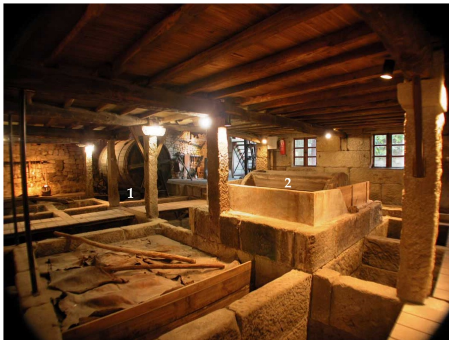
Figura 14. Tenería tradicional, con sistema de balsas intercomunicadas, tambor o bombo (1) y tanque con molinete (2). Fábrica de Curtidos Familia Nogueiras (Allariz, Orense).
