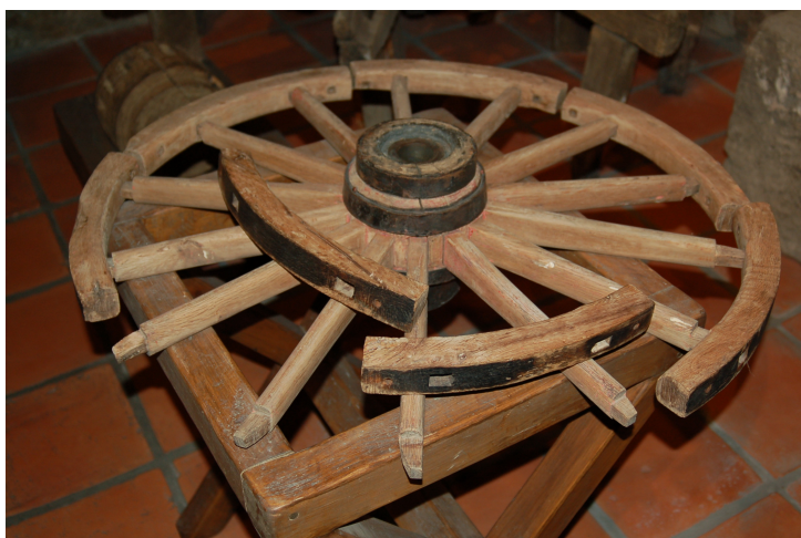
Figura 24. Pinas y radios de la rueda de un carro. Fuente: Museu del Traginer (Igalada).
