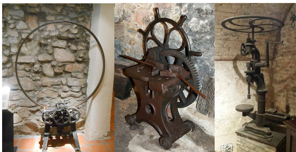
Figura 14. Curvadora (izquierda), recaladora (centro) y taladradora (derecha); fuentes: Ecomuseu La Vall d'Ora (Navés) y Museu del Traginer (Igualada).
