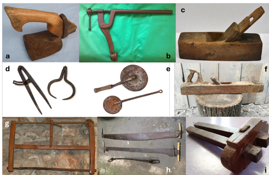
Figura 13. Herramientas de carretero. (a) azuela; (b) barrilete; (c) cepillo; (d) compases; (e) rodela; (f) garlopa; (g) sierra bracara; (h) tronizador; (i) gramil. Archivo UCM.
