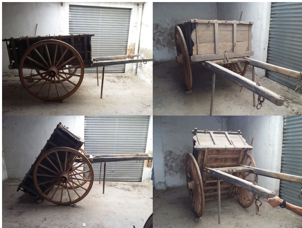
Figura 6. Carro volquete, en posición de marcha (fila superior) y en posición de descarga (fila inferior).
