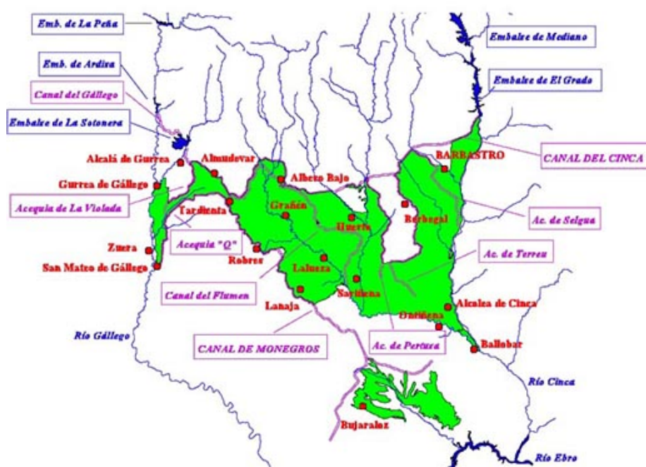
Figura 31. Esquema del sistema Gállego-Cinca. Faltan los embalses de Lanuza y Búbal, en el Valle de Tena, aguas arriba del río Gállego. Fuente: Riegos del Alto Aragón.
